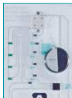
Beispielhafte Elektronik-Schaltung in FoilTronic®-Technik auf Polyester-Substrat
